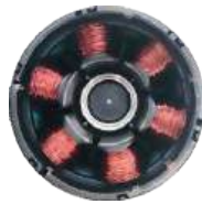
Sabit Mıknatıslı Motor
